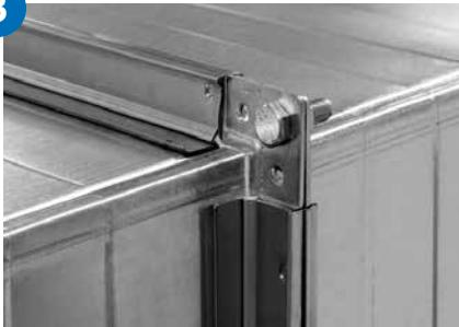
Přitlačte příruby k sobě a ve všech čtyřech rozích spojte přírubu šroubem s metrickým závitem, vějířovou podložkou a maticí. Šroub a matice M8 se používají s profilem RJFPC3 20.
